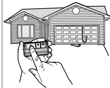
Si la puerta se detiene y no retrocede al hacer contacto con la obstrucción, se debe ajustar la carrera. Aumente el recorrido de cierre (consulte el paso 1 de la sección Ajustes).
