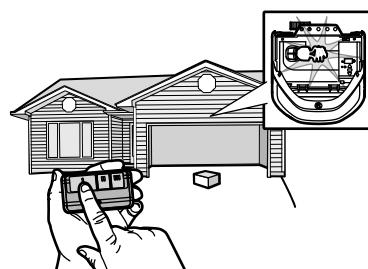
El abre-puertas de garaje no se cerrará mediante un control remoto si el LED del sensor de reversa de seguridad está apagado (alertándolo de que el sensor está mal alineado u obstruido).
