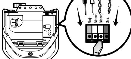
Para insertar o soltar el cable, empuje la lengüeta hacia dentro con la punta de un destornillador.
