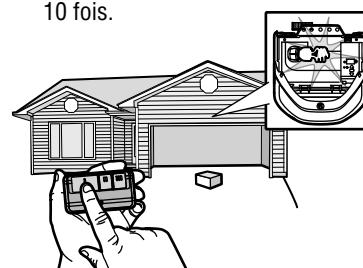
L'ouvre-porte de garage ne se fermera pas à l'aide d'une télécommande si le témoin DEL d'un des deux capteurs d'inversion est éteint (ce qui avertit que le détecteur est mal aligné ou obstrué).
