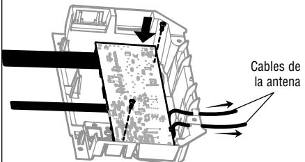
**NOTA:** En algunos modelos, el cable corto de la antena se deberá colocar en los compartimentos del panel posterior.
