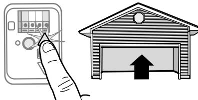
**NOTA:** Los botones ARRIBA y ABAJO se pueden utilizar para mover la puerta hacia arriba y hacia abajo según sea necesario.
