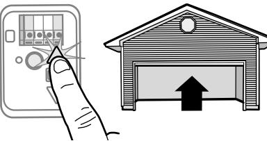
**NOTA:** Los botones ARRIBA y ABAJO se pueden utilizar para mover la puerta hacia arriba y hacia abajo según sea necesario.
