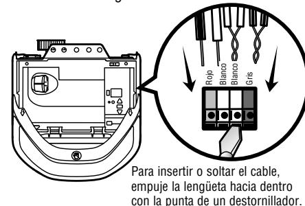
Para insertar o soltar el cable, empuje la lengüeta hacia dentro con la punta de un destornillador.
