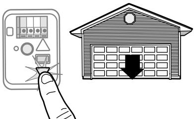
**NOTA:** Los botones ARRIBA y ABAJO se pueden utilizar para mover la puerta hacia arriba y hacia abajo según sea necesario.
