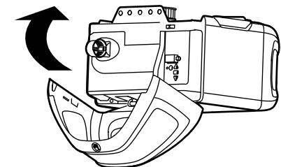
**REMARQUE :** Lors de l'installation de la lentille, s'assurer que les fils d'antenne sont orientés vers le sol.
