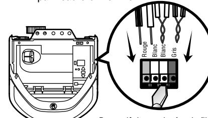
Pour relâcher ou insérer le fil, enfoncez la languette à l'aide de l'extrémité du tournevis.
