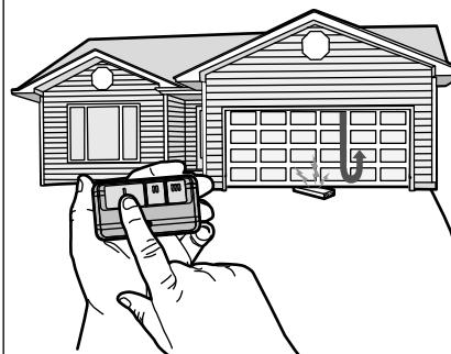
Si la puerta se detiene y no retrocede al hacer contacto con la obstrucción, se debe ajustar la carrera. Aumente el recorrido de cierre (consulte el paso 1 de la sección Ajustes).
