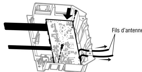
**REMARQUE :** Certains modèles nécessiteront que le fil d'antenne court soit placé dans les trappes du panneau d'extrémité.
