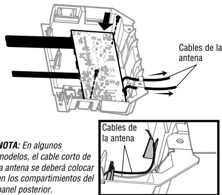
**NOTA:** En algunos modelos, el cable corto de la antena se deberá colocar en los compartimentos del panel posterior.
